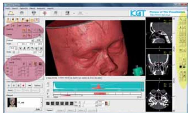
Figura 3. Imagem da tela do computador com programa mostrando renderização de volume 3D. Nas elipses roxas se visualizam os comandos para “dissecção” virtual, cortes livres (“free cuts”), além de controles para rotação e orientação deste volume 3D. Note elipse amarela com comandos para seleção (que pode ser manual ou automática) de áreas tanto nas reconstruções 2D, quanto nas reconstruções de volume 3D, para posterior segmentação e/ou supressão de algumas densidades.
